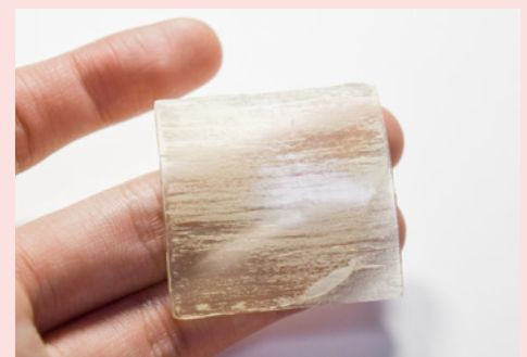
南谷幹人「透明木材が拓く建築の新たな可能性」 (Bコース2019年度中村達太郎賞)
